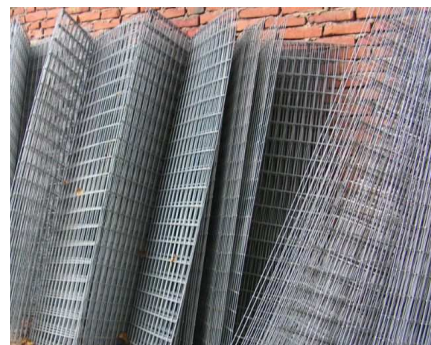
Moduly z gabionových sítí FeZn pr. 4 mm ohnuté do požadovaného úhlu.
